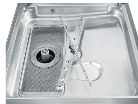
Das im Tank platzierte **innovative, dreistufige Selektiv-Filtersystem** in Kombination mit dem **Teiltankwasserwechsel** sorgen bei jedem Spülgang für saubere Laugenwasserqualität.
